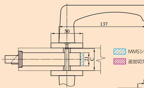
■ MMSシリーズ(バックセット76)の切欠を示す
