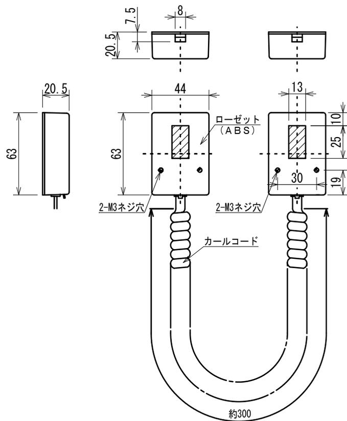
面付型通電金具の施工例図
