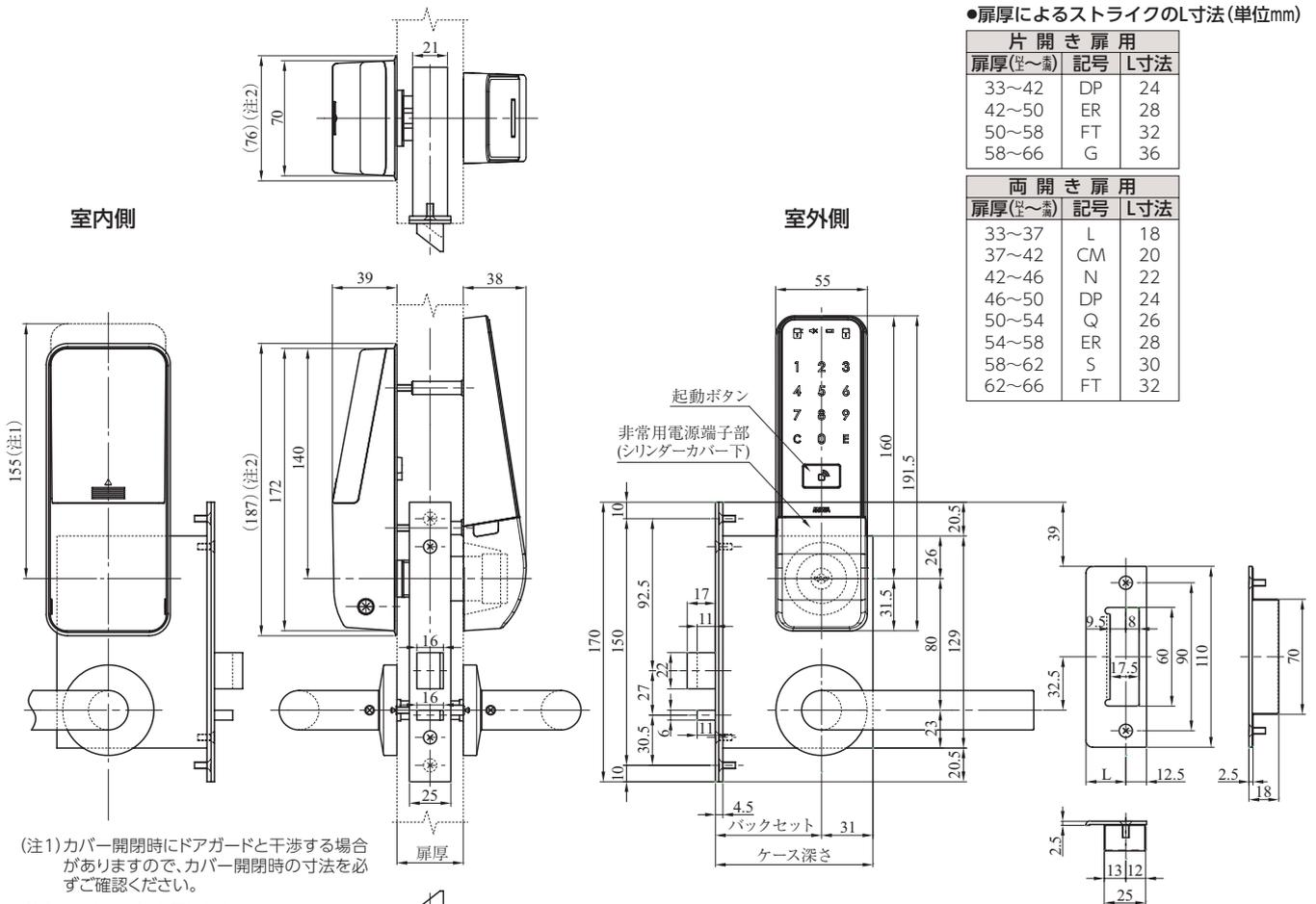
(注1) カバー開閉時にドアガードと干渉する場合がありますので、カバー開閉時の寸法を必ずご確認ください。
